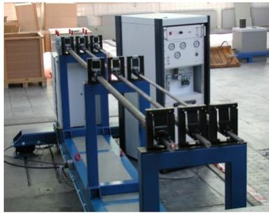
Abbildung 1.3: PTB Stoßbeschleunigung Normalmesseinrichtung 100.000 m/s<sup>2</sup>[PTB2]
